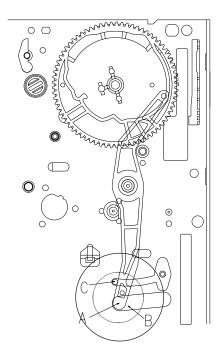
Fig.4-2 DATUM POSITION OF RELAY LEVER & CAM GEAR
